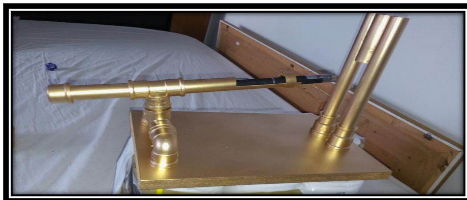
Figura 6.6 – Microscópio Caseiro de PVC a laser
