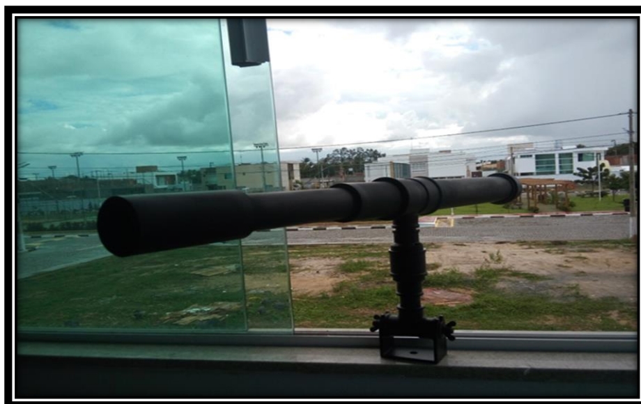
Figura 6.13 – Luneta astronômica com ajuste auto azimutal
